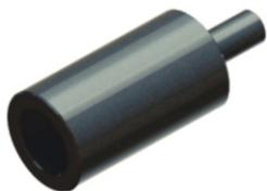
Dispositivo para ajustar a altura do bujão das UI - bujão Scânia
