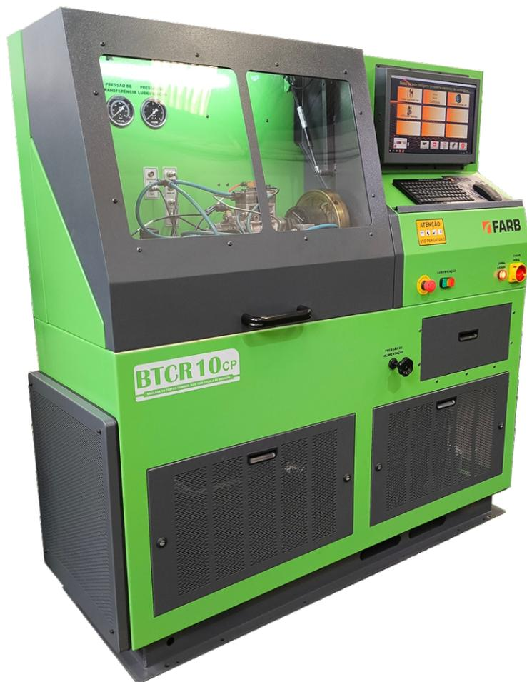
A bancada de testes FARB modelo BTCR-10 CP é uma bancada de alta tecnologia, precisão e eficiência. Têm a capacidade de testar bicos indutivos e piezo elétrico, bombas Common Rail, Injetores (Bosch, Bosch Piezo, Denso, Denso Piezo, Delphi, Caterpillar C4 e C6, Siemens, bicos Scania XPI e Crin 4.2) e Bombas (Bosch Cp1, Cp2, Cp3, Cp4, Denso, Delphi, Siemens, Caterpillar C4 e C6) através de célula de medição.
