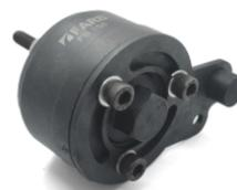
Dispositivo para sacar a bomba da Renault Mastar e manter o sincronismo da engrenagem
