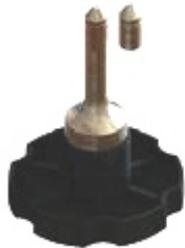
Ferramenta para retificar o acento das esferas da bomba Cp3  $\varnothing$ 8mm cone de 70°
