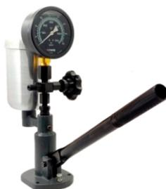
Teste para bicos injetores mecânicos com pressão de até 400Bar
