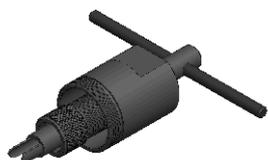
Dispositivo para desmontar e montar as molas do regulador RQV
