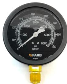
Manômetro do teste de bico 0 a 400Bar
