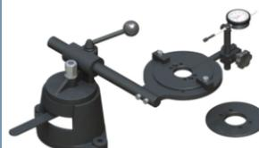
Morsa giratória com dispositivo de fixação com haste magnética para medir a altura da válvula das unidades UP Mercedes Benz
