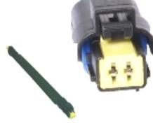
Conector para válvula Siemens/Delphi
