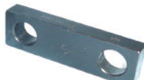
Gabarito para medir o eixo de comando para bombas P 25mm e 30mm
