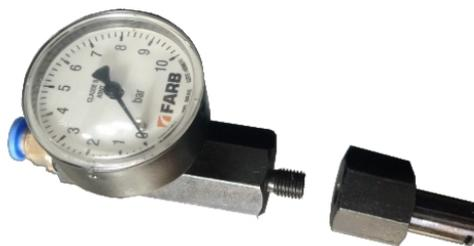
Válvula para pressurizar o retorno dos bicos à 4 bar
