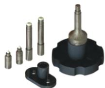
Ferramenta diamantada para retificar o assento das esferas da bomba CP1H  $\varnothing$ 6,75 cone de 90° e  $\varnothing$ 3,6 cone de 60°
