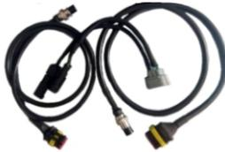
Teste para sensores de pressão em geral e teste de comunicação para bicos Denso Hilux
