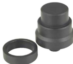
Dispositivo para montagem das capas do rolamento da bomba P
