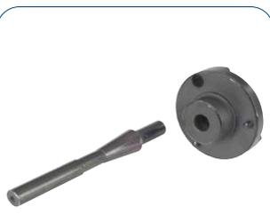
Dispositivo para centralizar as lâminas do acoplamento da bomba 7100
